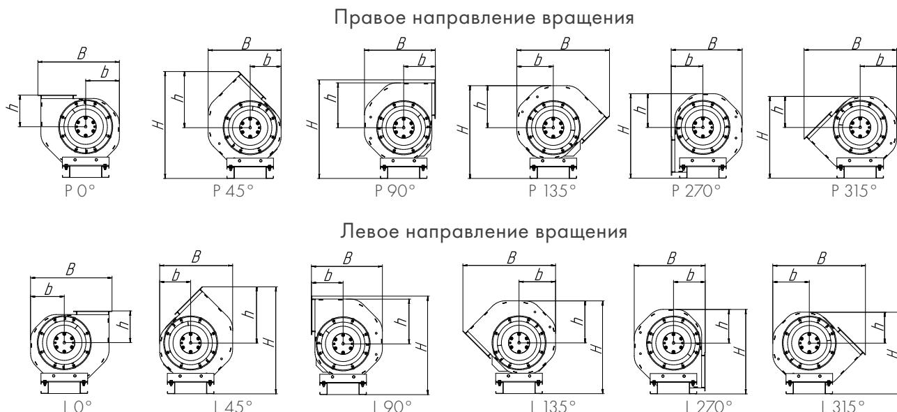
Рисунок 16 – Направление вращения и углы поворота спирального корпуса радиальных вентиляторов в сейсмостойком исполнении
