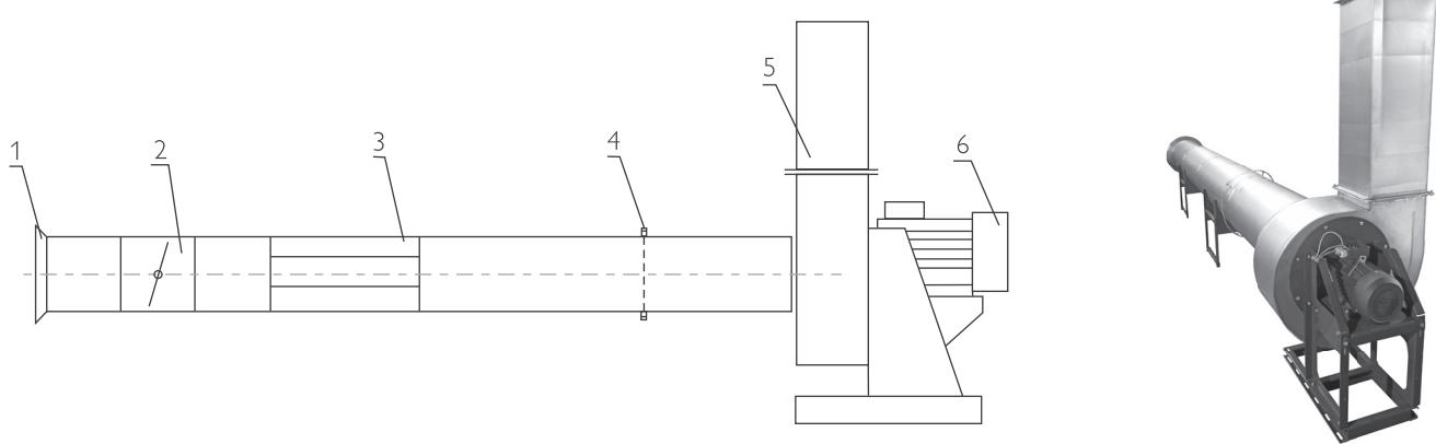
Рисунок 1 – Схема стенда тип С ГОСТ 10921-2017
