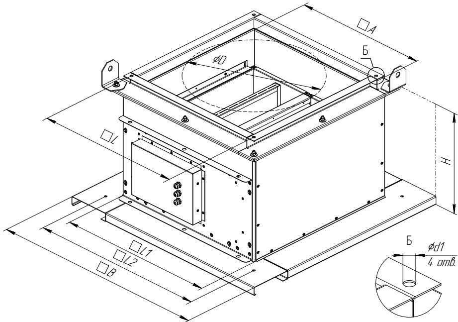
Рисунок 32 – Основные размеры монтажных стаканов с противопожарным клапаном
