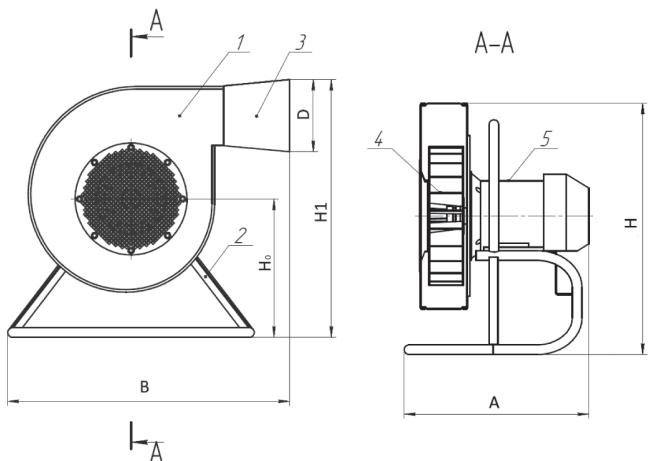
Рисунок 33 – Конструкция вентилятора:
