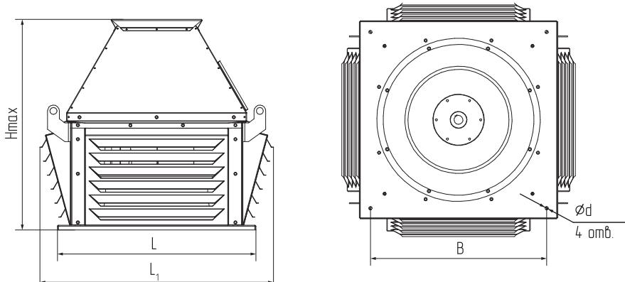
Рисунок 27 – Основные размеры вентиляторов крышных радиальных VKRS
