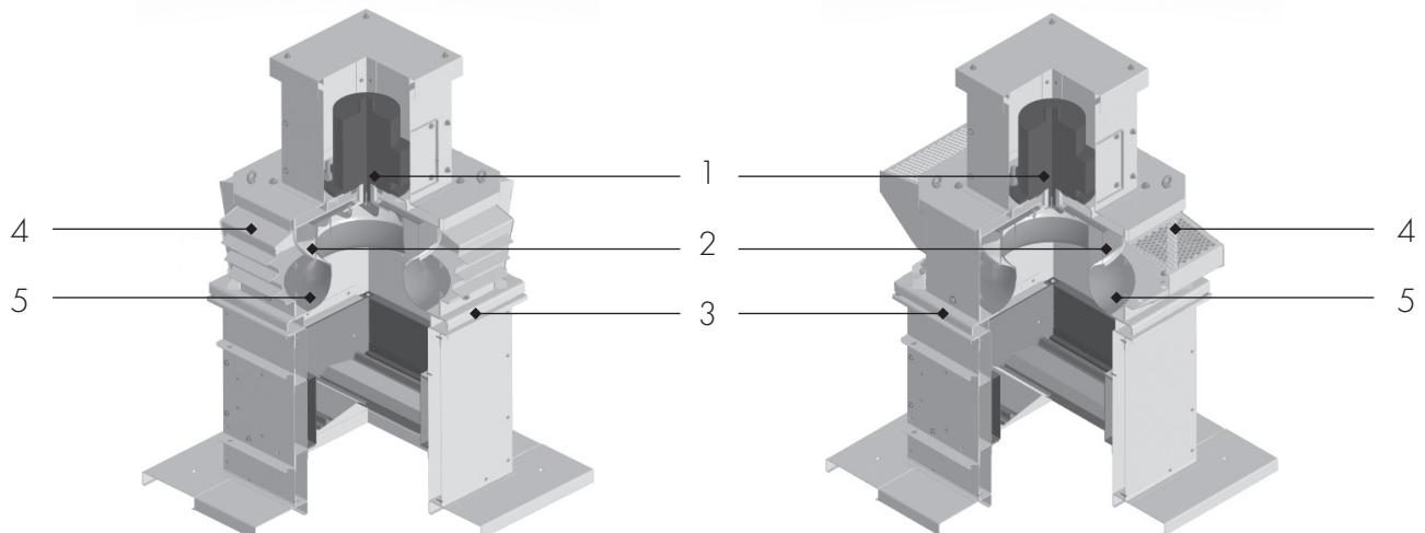
Рисунок 25 – Устройство и основные элементы крышных радиальных вентиляторов в сейсмостойком исполнении
