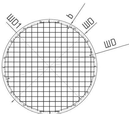
Рисунок 19а – Основные размеры круглых защитных решеток
