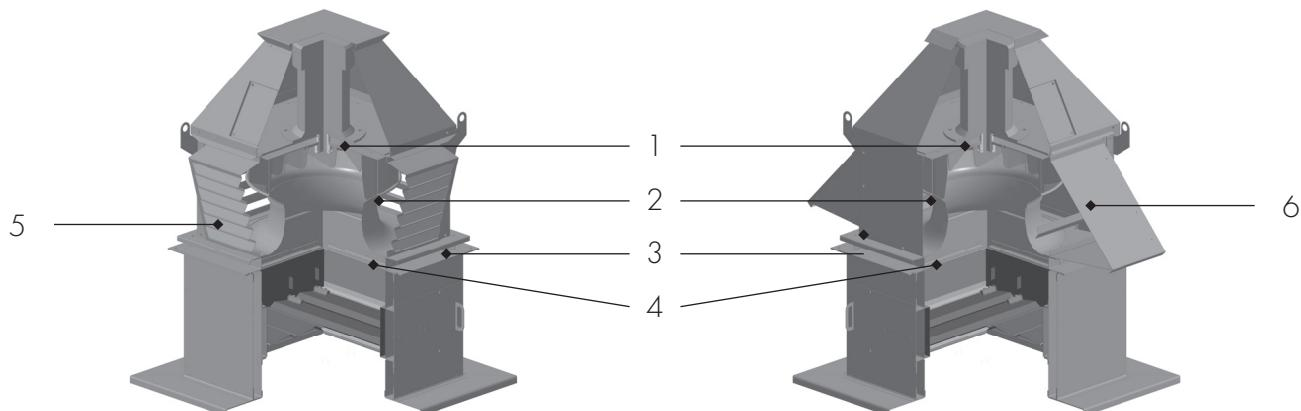
Рисунок 24 – Устройство и основные элементы крышных радиальных вентиляторов
