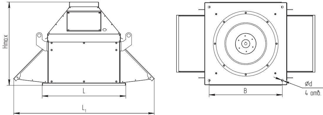
Рисунок 29 – Основные размеры вентиляторов крышных радиальных VKRF
