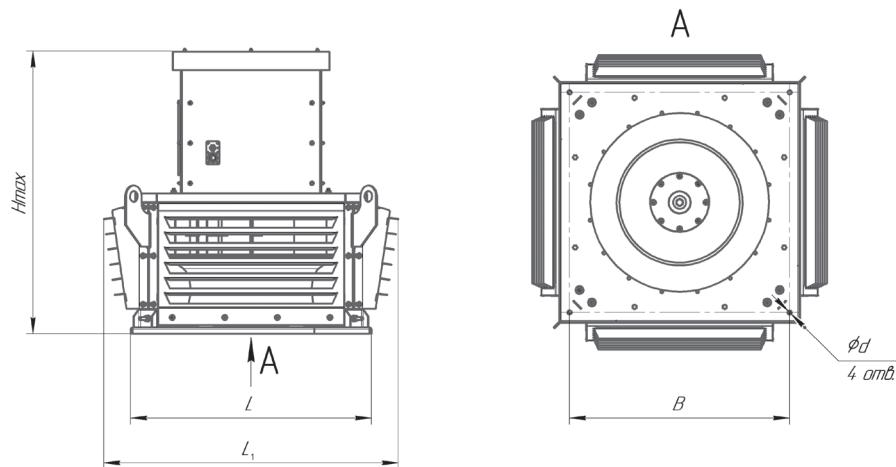
Рисунок 28 – Основные размеры вентиляторов крышных радиальных VKRS
