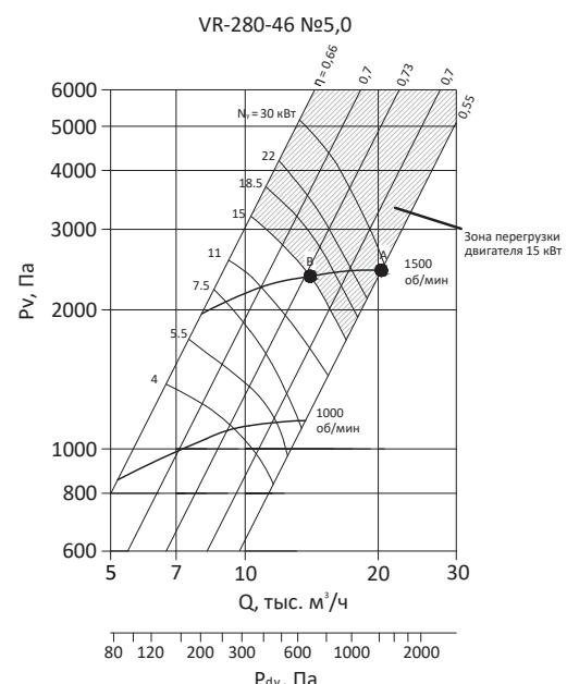
Рисунок 2 – Типовой график аэродинамических характеристик вентилятора
