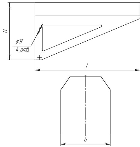
Рисунок 23а – Основные размеры защитного кожуха\* (исп. 1)
