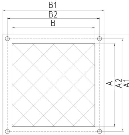
Рисунок 19б – Основные размеры прямоугольных защитных решеток
