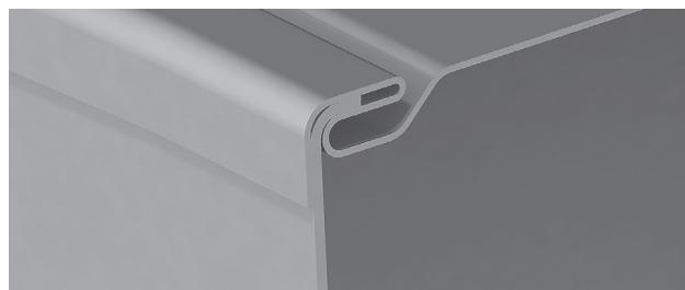
Рисунок 6 – Сборка корпуса вентилятора на «питтсбургском фальце»
