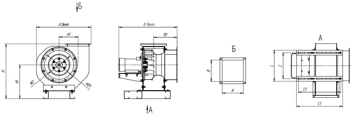
Рисунок 10 – Основные размеры радиальных вентиляторов низкого давления VR-86-77-S
