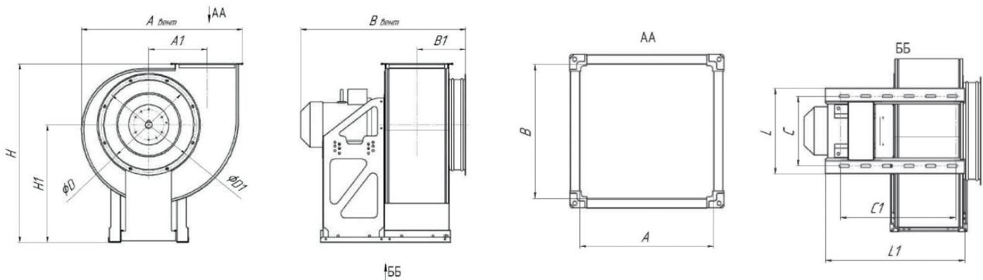
Рисунок 9 – Основные размеры радиальных вентиляторов низкого давления VR-86-77
