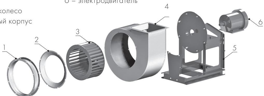
Рисунок 5 – Устройство и основные элементы радиального вентилятора
